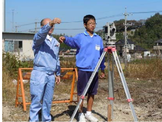
測点設定作業 (上) トランシット用いて測点確定 (左)
