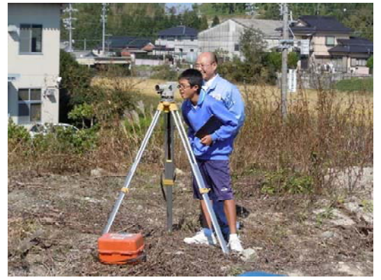
レベルでの水準測量 (右) 掛矢をふって測点杭設置 (下)
